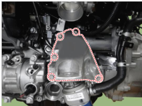
7. 拆卸油尺导管(A)。
